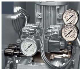
SHARK NC 5.0 Регулятор давления гидравлических
