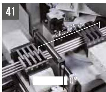
TIGER 352 NC 5.0 макс. 70x70 мм - мин. 8x8 Комплект комбинированных губок для зажима при одновременной обработке нескольких заготовок
