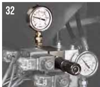
SHARK SXI evo Регулятор давления гидравлических тисков
