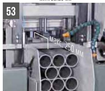
53 SHARK 230 NC 5.0 - Вертикальные гидравлические тиски для пакетной резки (макс. 230x230 мм)
