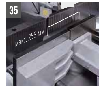
SHARK 332 NC 5.0 Специальные тиски для уменьшения длины остающегося прутка
