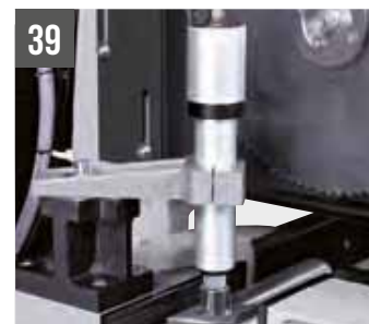
TIGER 352MA/COBRA 352MA Пневматические вертикальные тиски
