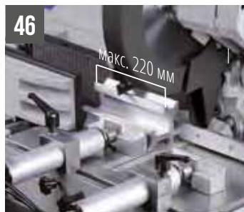
46 COBRA 352 NC 5.0 Специальные тиски для уменьшения длины остающегося прутка
