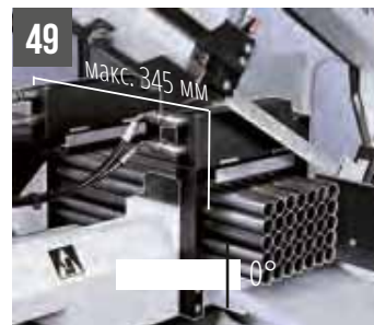
49 SHARK 281 NC 5.0 - Вертикальные гидравлические тиски для пакетной резки (макс. 170x130 мм)
