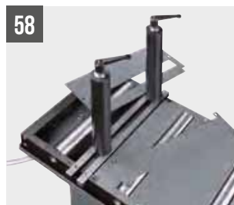
58 Комплект, два вертикальных ролика и защитная крышка для роликового стола K110HD
