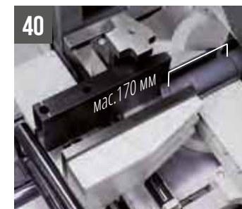
TIGER 352 NC 5.0 Специальные тиски для уменьшения длины остающегося прутка
