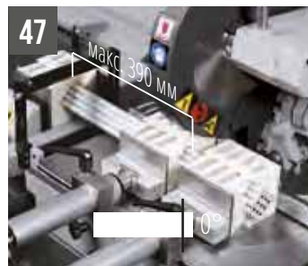
47 COBRA 352 NC 5.0 - Комплект комбинированных тефлоновых губок для зажима при одновременной обработке нескольких заготовок макс. 75x75 мм - мин. 20x20 мм
