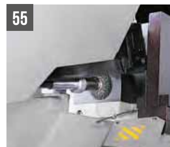
55 SHARK 332 SXI/NC 5.0 - 382 SXI Моторизированная щётка для удаления стружки с режущего полотна
