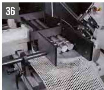
SHARK 332 NC 5.0 Устройство для обработки нескольких заготовок и регулятор отрезных частей (макс. 240x90)
