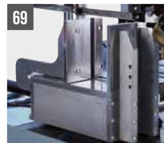
SHARK 230 NC HS 5.0 Тиски в зоне реза с зажимом с двух сторон
